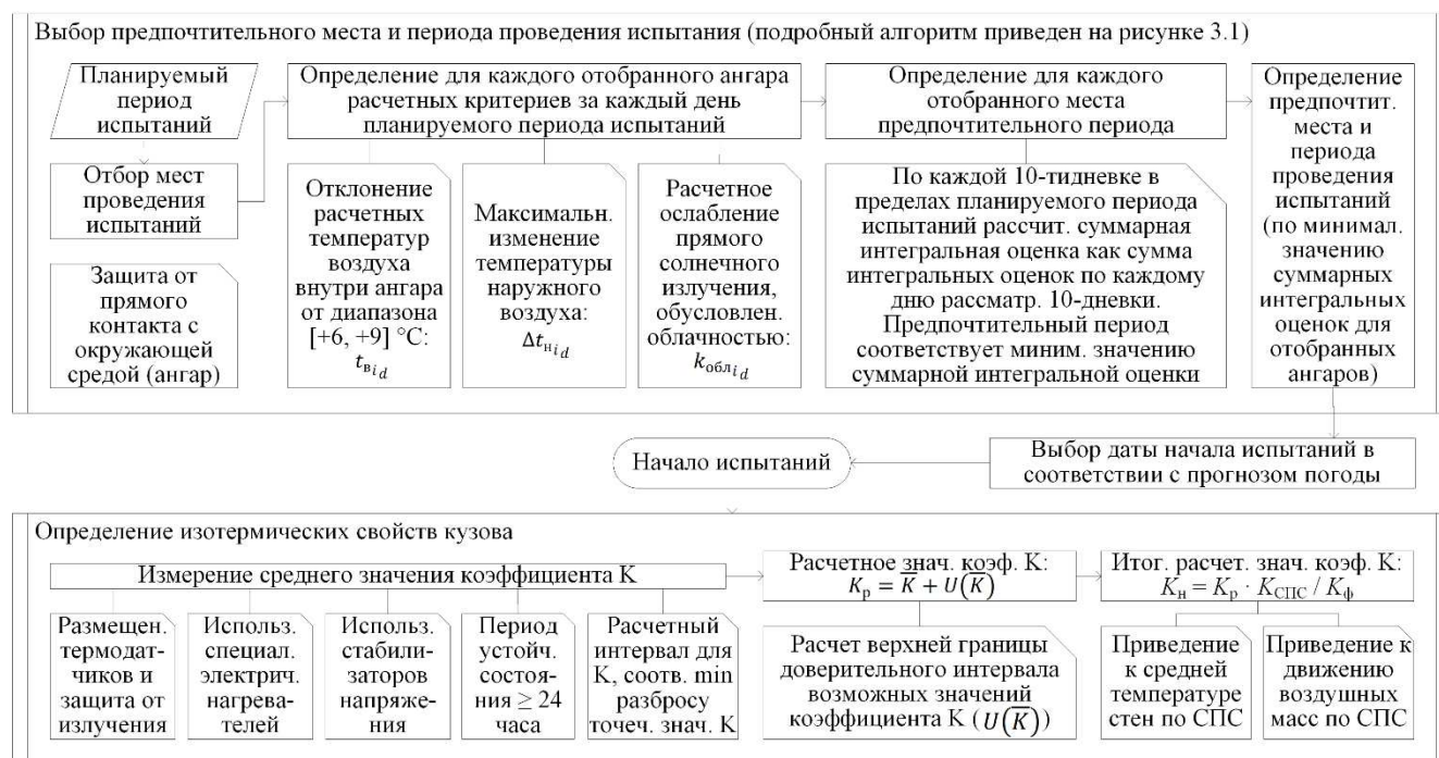
Рисунок 3.4 – Этапы и шаги методики определения в условиях отсутствия камеры расчетного значения коэффициента K как нормативного параметра для установления технологии перевозки скоропортящегося груза в СТС
